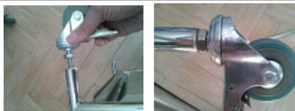
2. Encaje el bastidor trasero (con gancho) en el soporte y atorníllelo.
